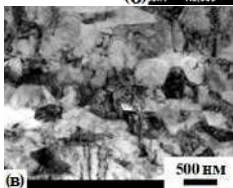
Микроструктура сплава ВТ6 (а) в КЗ состоянии, РЭМ; после ИПД: РЭМ (б), ПЭМ (в)
